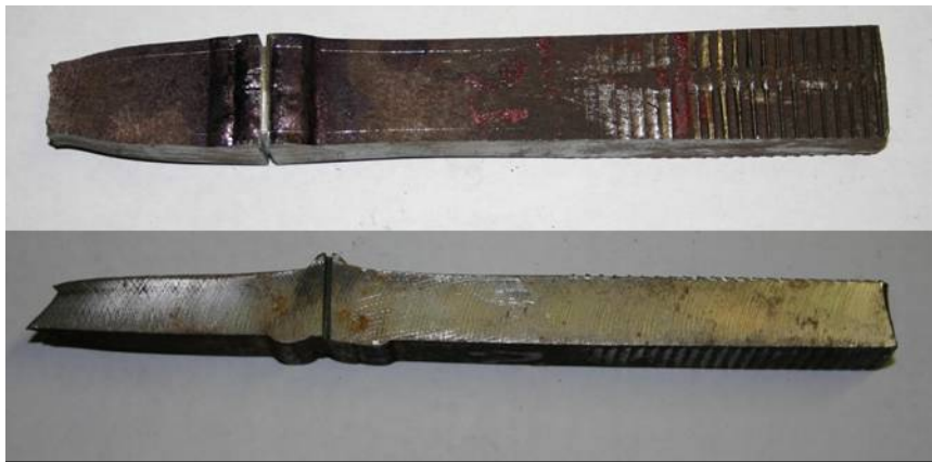
Fig. 12: Resultados do teste de nick break.
