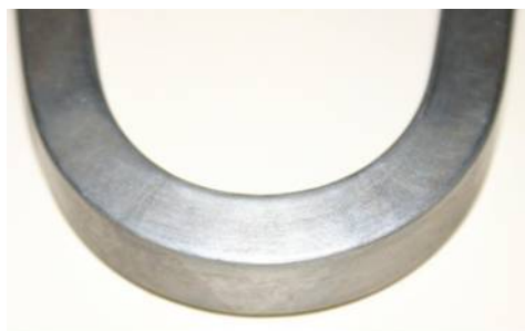
Fig. 10: Teste de dobramento.
