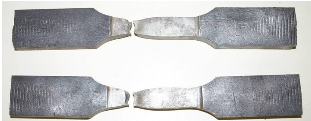
Fig. 9: Teste de tração.
