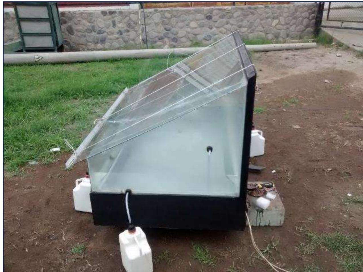
Las dimensiones internas: 80 cm de altura (parte trasera), 75 cm de ancho, 135 cm de largo y 35 cm de altura (parte frontal), una cámara de volumen de  $0,58 \text{ m}^3$
