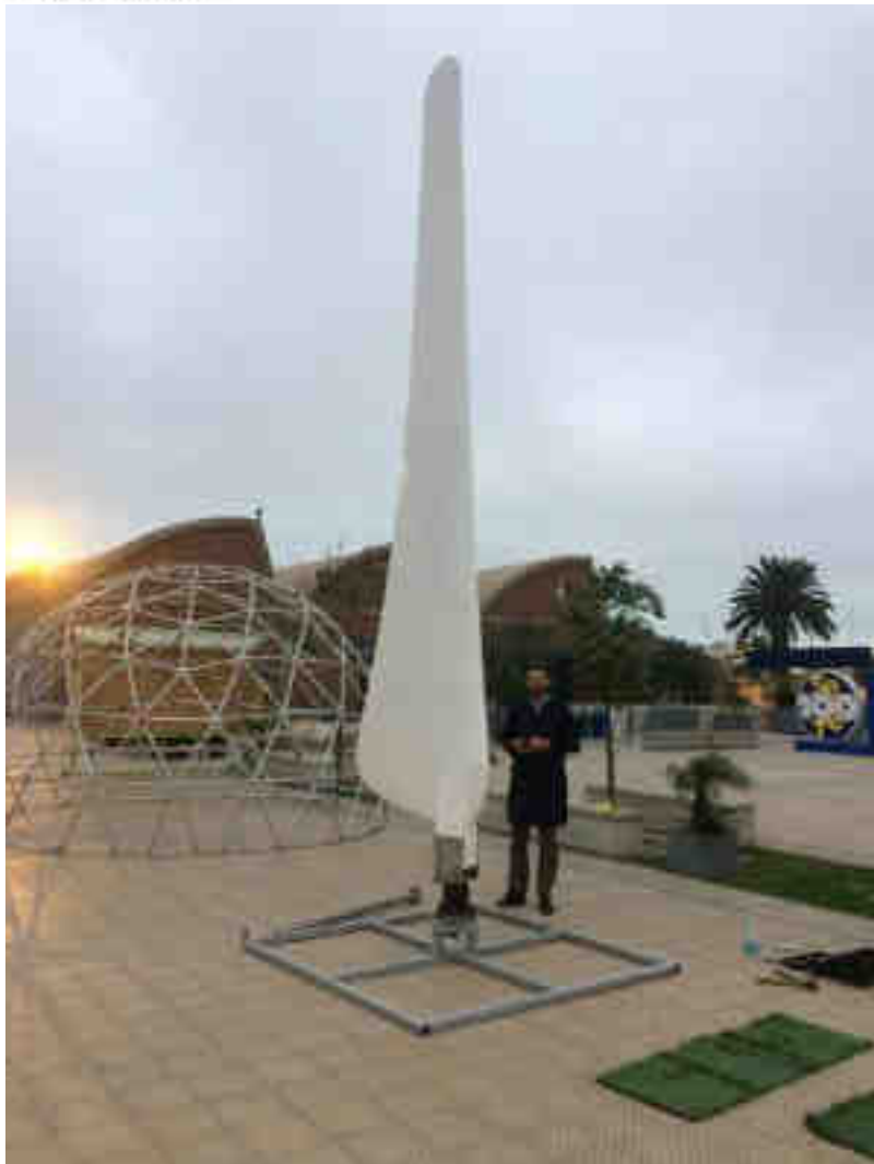
Pala de 6 m fabricada en fibra de vidrio/poliéster y espuma PVC
