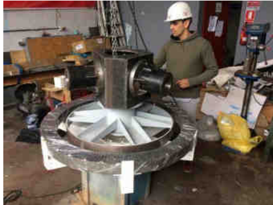
Generador de 25 kW síncrono de 60 polos con bocamasa y mecanismo de paso variable.
