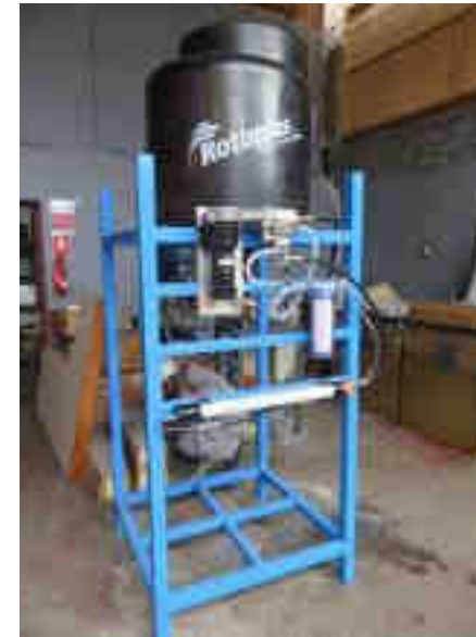
Planta desalinizadora de 300 Litros /día
